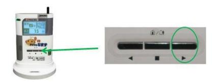
デジタルなまず本体の前面にある3つの押ボタンのうち、右のボタン(緑色)を3秒程度ほど長押しすると、 訓練・試験放送の画面に変わりますが、バージョンによって画面が異なりますので、以下を参照して下さい。
